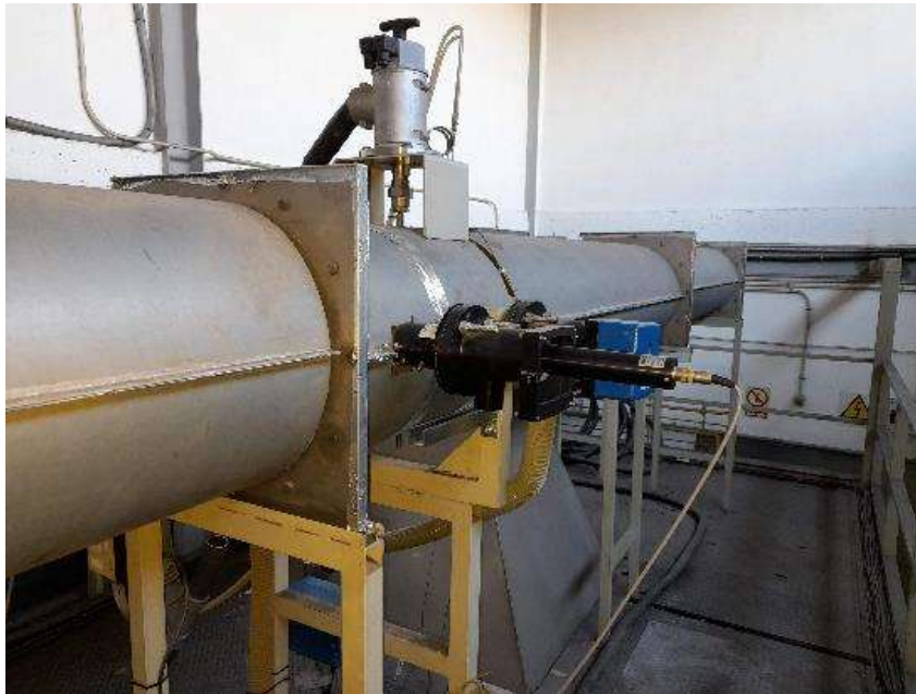
Tubo extracción de humos SBI y sistema fotométrico de detección de humos.
