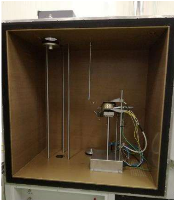
Interior de la cámara de emisión de humos ( smoke box )
