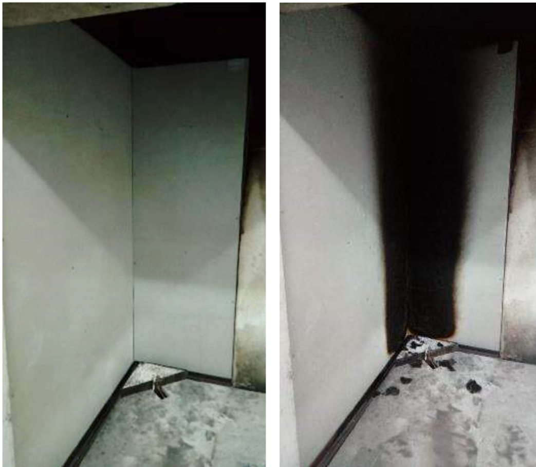
Probetas CHEMTOX-19 antes y después ensayo SBI.
