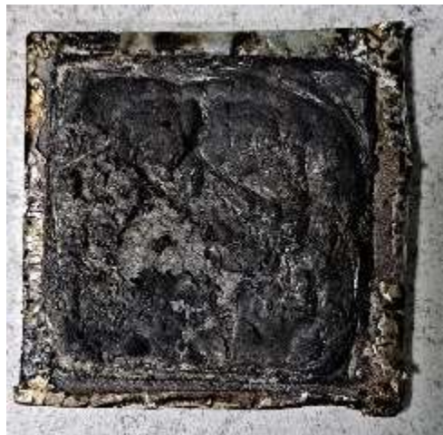
Probetas CHEMTOX-19 después ensayo como calorimétrico
