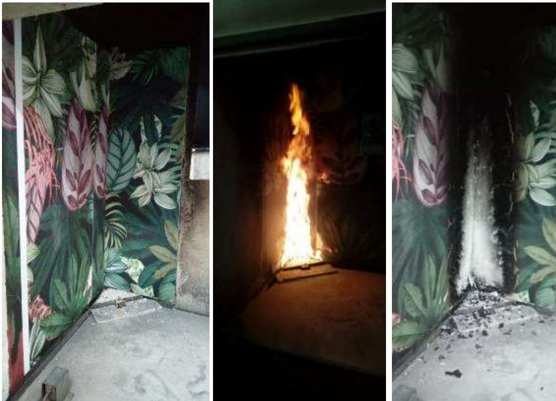
De izquierda a derecha: Muestra papel pintado antes del ensayo SBI, durante ensayo y después.
