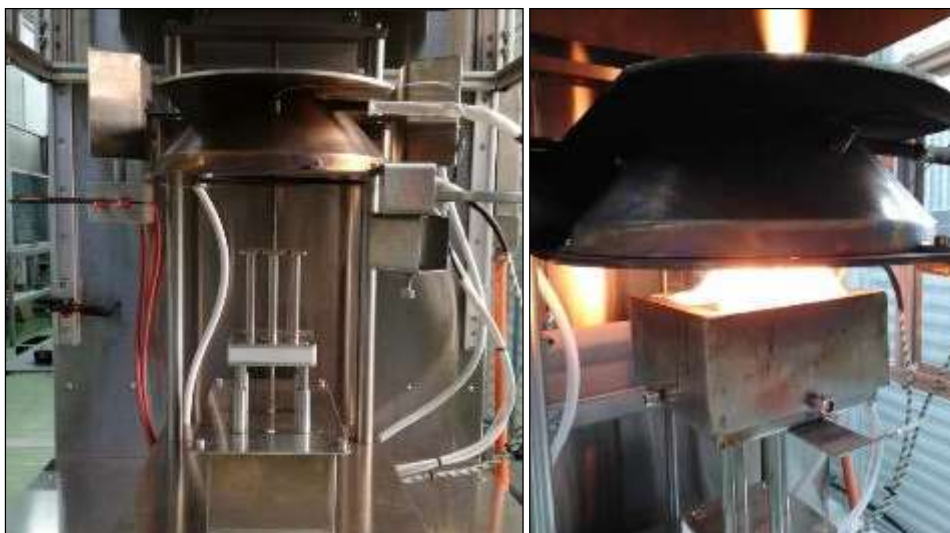
Disposición del cono calefactor y ejemplo de irradiación sobre una muestra.
