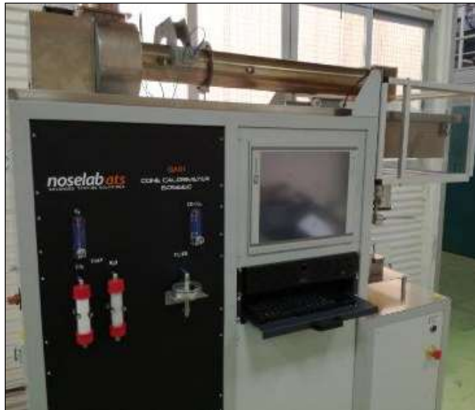
Vista frontal del equipo del cono calorimétrico donde se observa en la superior el tubo de medición de humos.
