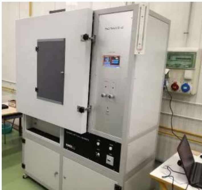
Cámara de emisión de humos ( smoke box )
