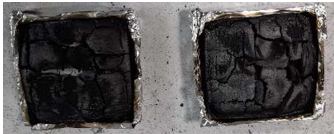
Probetas CHEMTOX-14 después cámara humos
